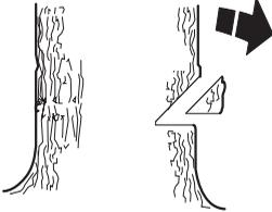
Направляючі вирізи повинні бути зроблені на глибину 1/4 діаметра стовбура та кут між нижнім та верхнім розрізами має бути 45°.
