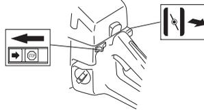
Якщо інструмент обладнаний клапаном зниження тиску (A): Натисніть на клапан, щоб зменшити тиск у циліндрі та полегшити запуск. Завжди використовуйте клапан зниження тиску при запуску інструмента. Після того як інструмент запустився, клапан автоматично вернеться в початкове положення.
