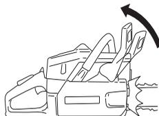
Відкрутіть гайки, що кріплять кришку зчеплення (ланцюгове гальмо). Зніміть кільце для транспортування (А).
