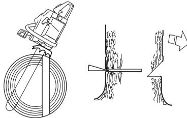
Закінчіть роботи виріз зрізування паралельно лінії напрямку розрізу, щоб відстань між ними була не менш 1/10 діаметра стовбура. Нерозрізана частина стовбура називається розріз падіння.
