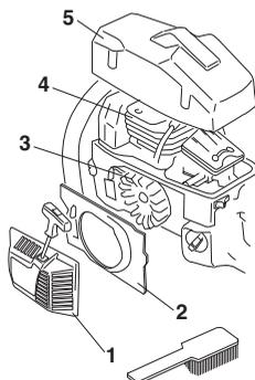
Систему охолодження слід чистити раз на тиждень, а якщо цього вимагають умови, то частіше. Робота з забрудненою або забитою системою охолодження спричинить перегрів двигуна, що призведе до пошкодження циліндру та поршня.
