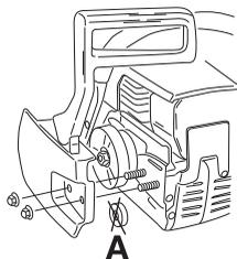
Закріпіть направляючу шину гвинтами. Установіть направляючу шину. Одягніть ланцюг на барабан приводу на канавці направляючої шини. Почніть із верхньої крайки направляючої шини. Упевніться, що крайки ріжучих ланок глядять нагору на верхній крайці направляючої шини.
