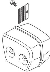
Глушник призначений для зменшення рівня шуму та відведення вихлопних газів подальше від користувача. Вихлопні газы мають високу температуру і містять іскри, які, потрапивши на сухі та легкозаймисті речовини, можуть привести до загоряння.
