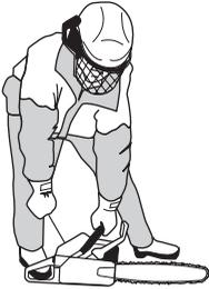
Якщо ланцюгове гальмо ще активоване, треба перевести двигун в роботу на холостому ході якомога швидко, це робиться за допомогою фіксатора дроселя. Це допоможе уникнути непотрібному зносу зчеплення, барабана зчеплення й гальмової стрічки.
