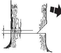
Установить шпичастий буфер (якщо є) перед шарніром падіння. Працюйте на повній швидкості та повільно уріжтеся ланцюгом/направляючою шиною в дерево. Упевніться в тому, що дерево не починає рухатися в напрямку, який зворотний тому, що Ви вибрали для валки. Забийте клин для валки дерев чи лом у розріз, як тільки він став досить глибоким.
