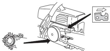
Закріпіть кришку зчеплення та вставте натяжний гвинт ланцюга в отвір на направляючій шині. Перевірте, щоб ланки приводу ланцюга співпадали з барабаном приводу та що ланцюг правильно встановлений
