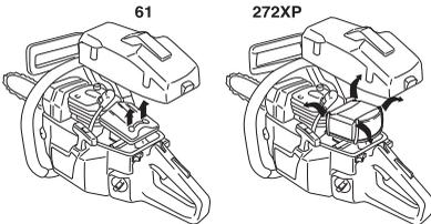
Фільтр може бути очищений ще краще промиванням його у воді з миючим засобом.
